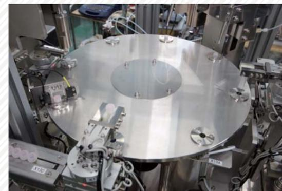
SD8000: 自動分注・キャッピング装置 (液体・粉体)
